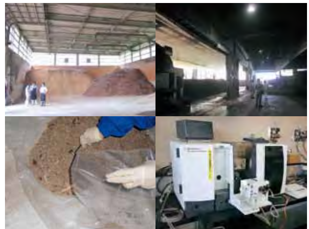
図2 立入検査の様子(左右上)、肥料の採取(左下)、成分分析に使う原子吸光分光光度計(右下)
